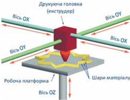
Мал. 2.106. Схема друкування об'єкта на 3D-принтері типу FDM
